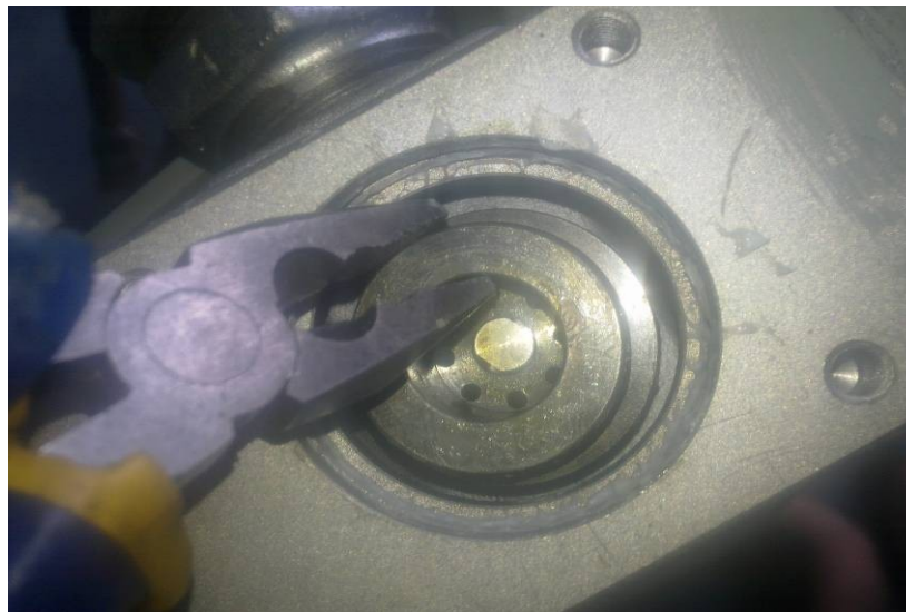
Извлечение поршня с помощью плоскогубцев
