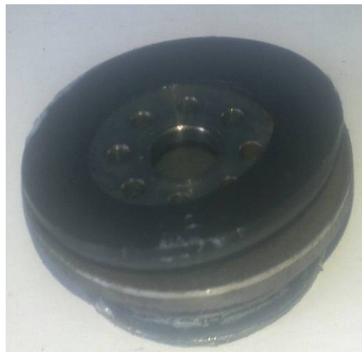
Замятие уплотнительного кольца поршня
